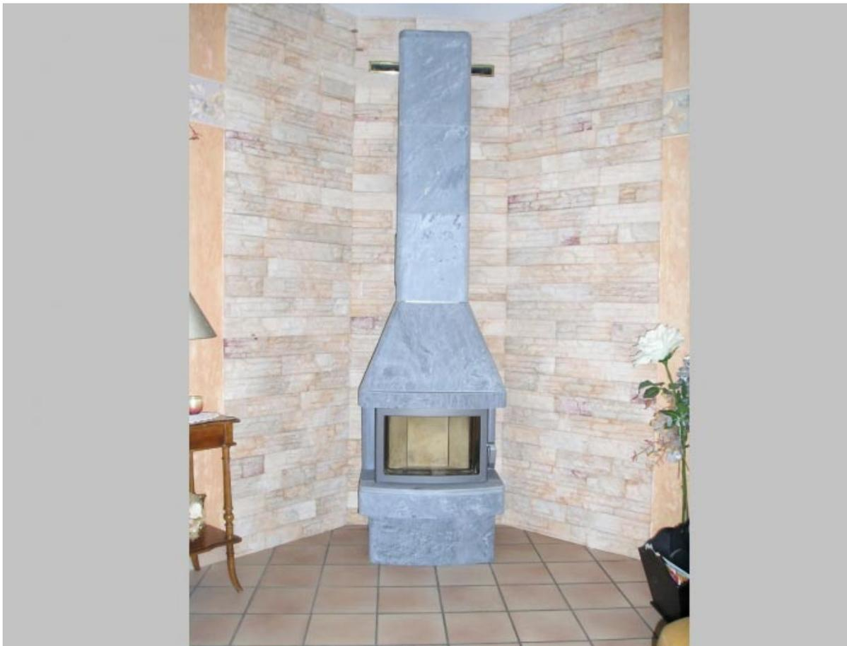
*Installation d'un poêle à bois suédois Contura 470, ce poêle d'une puissance de 9 kw possède une accumulation de chaleur avec c'est 250kg de pierre ollaire qui lui permet d'avoir une restitution de chaleur de 3 à 5 heures après la fin de combustion. Comme la plupart des poêles nordique il possède une grande qualité de combustion et un rendement de 80%*
